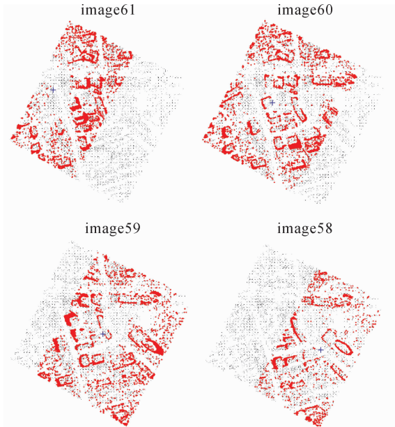
图 8 不同影像上的区域遮挡图 Fig. 8 Occlusion maps in the different images
